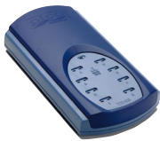
PicoLog TC-08 温度数据记录器 8 通道, 20 位分辨率、测量范围为 -270°C 至 +1820°C
